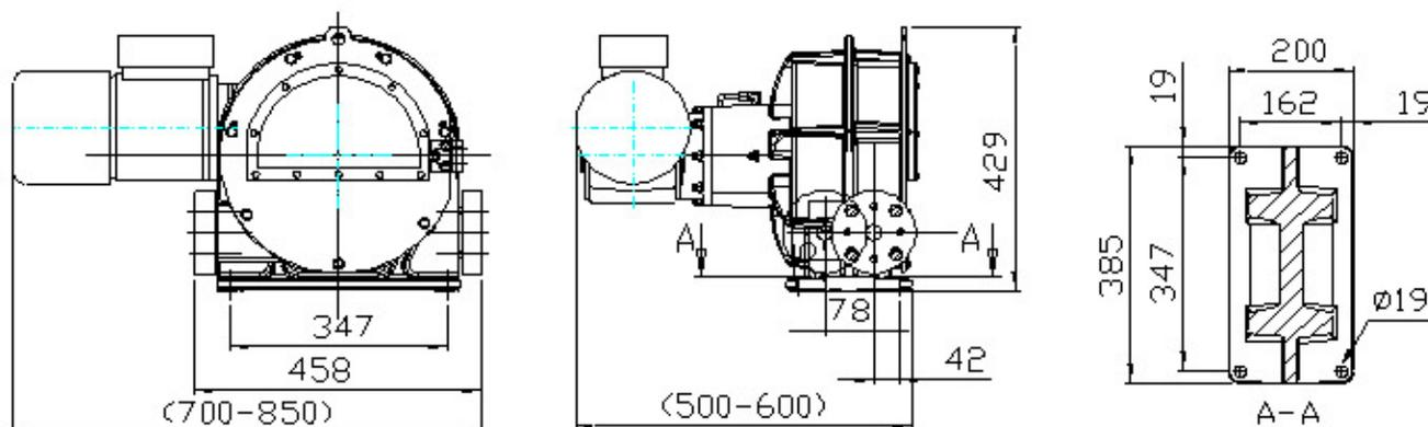
Dimensiones (X,Y) varían dependiendo del tamaño del motor. Por favor consulte con Larox Flowsys Oy para el dimensionamiento del motor para su aplicación.
