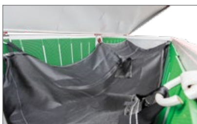
Geotextileinheit trennt effektiv Feststoffe von Wasser.
