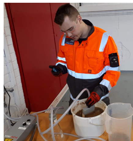
El equipo cerámico simple de prueba de inmersión cabe en un maletín más pequeño y requiere menos espacio.
