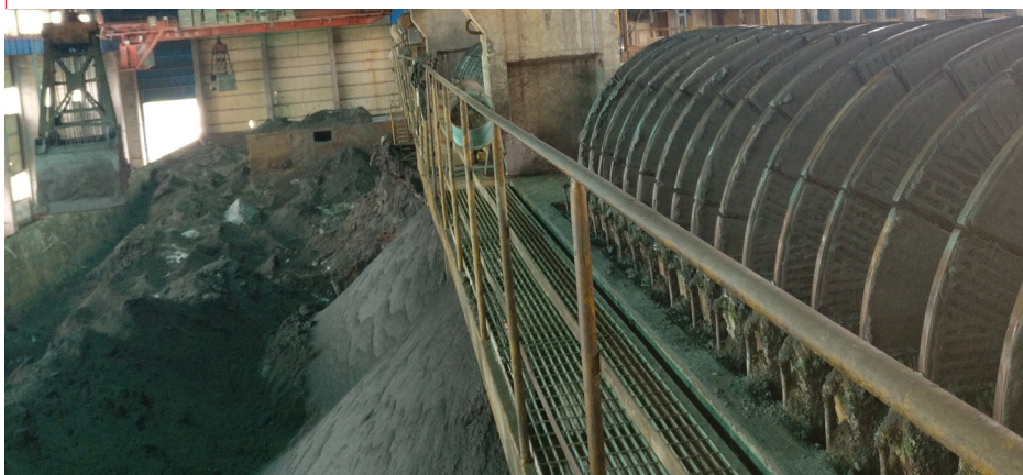
Der Flowrox-Keramikscheibenfilter eignet sich hervorragend für die Filtration von Kupferabgängen.
