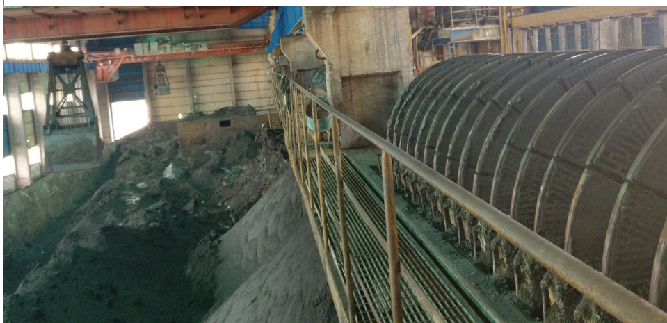
Keraaminen Flowrox-Kiekkosuodatin toimii erittäin hyvin kuparilietteen suodatuksessa.
